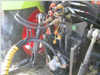
“Durante el levantamiento, es importante que los cables hidráulicos dispongan de suficiente espacio para mover sin problemas hacia la derecha o la izquierda.”
